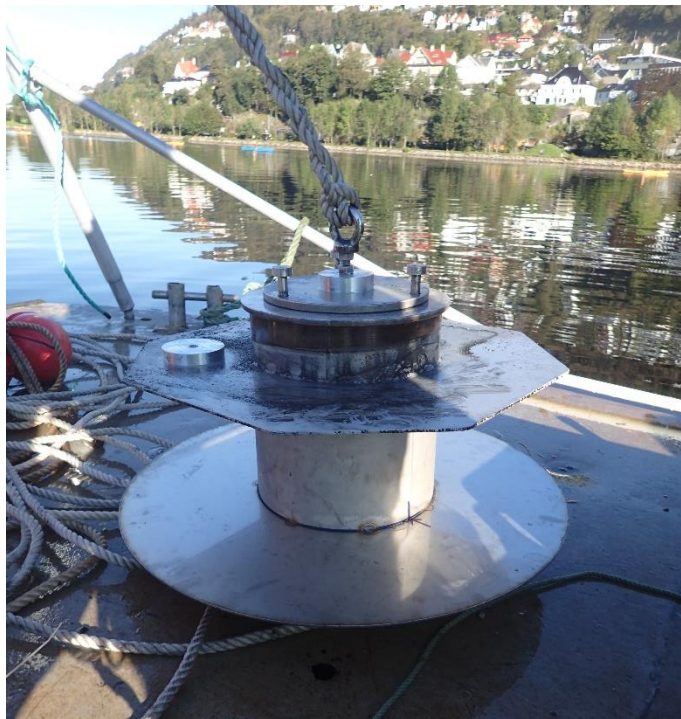
Figur 31 Modifisert flukskammer med ekstra hatt og lengre "hals".
