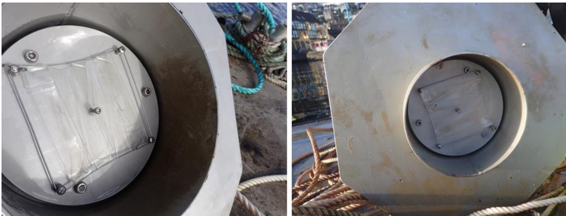
Figur 6: Flukskammer tatt opp ved St. 6. Ingen synlig ring som indikerer hvor sedimentet har stått i noen av prøveomgangene. Filming viste at det stod riktig ved prøveomgang 2 (t.h.).
