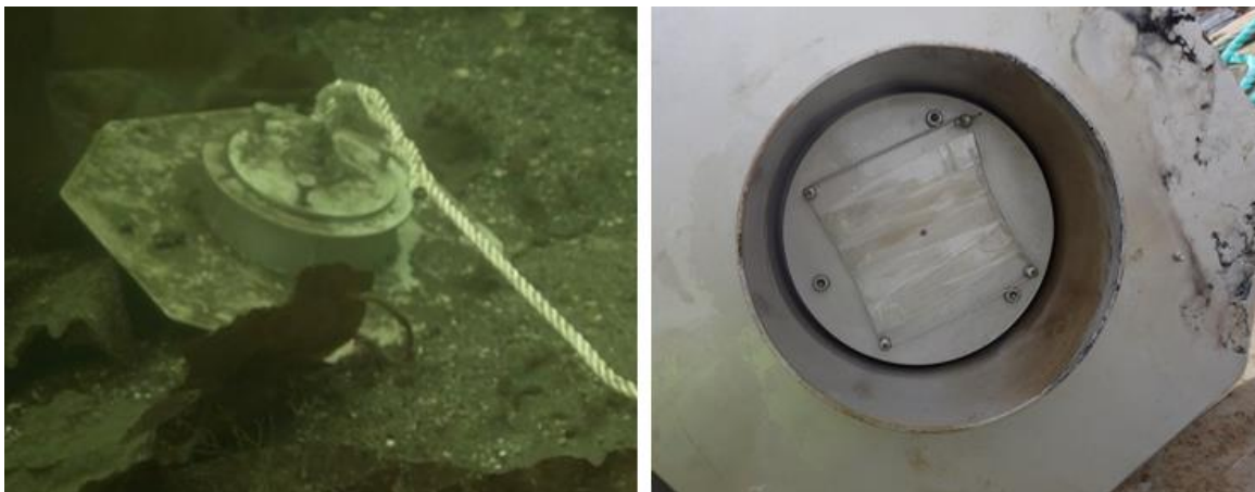
Figur 2: T.v. Utklipp som viser stasjon 5, filmet 20.aug. Flukskammeret står ikke som det skal. Film: Espen Rekdal. T.h SPMD ved opptak 5. sept. Det er ikke mulig å se på kammeret at det ikke har stått som det skal.
