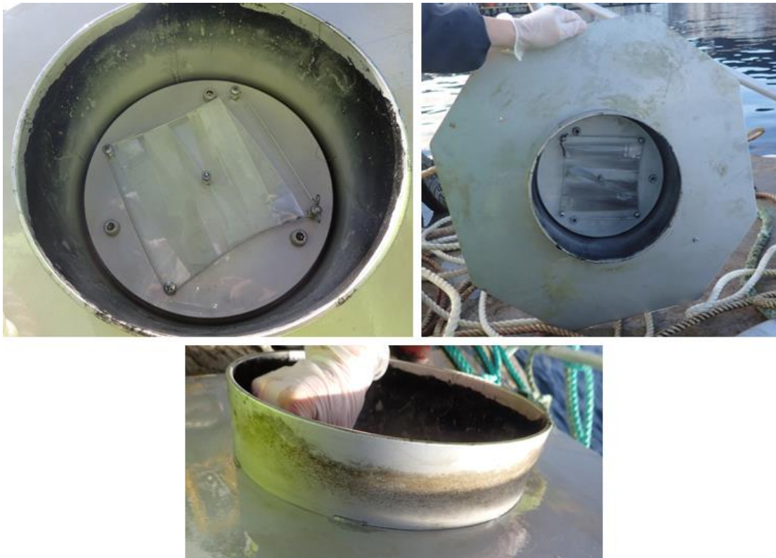
Figur 8: St.8. Synlig ring inni og utenpå kammeret som viste hvor høyt sedimentet hadde stått ved begge prøveomgangene.
