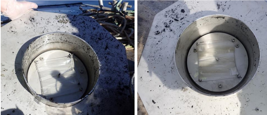
Figur 5: Flukskammer tatt opp ved St. 4. Ved begge prøveomgangene var det synlig ring i kammeret som viste hvor høyt sedimentet har stått.
