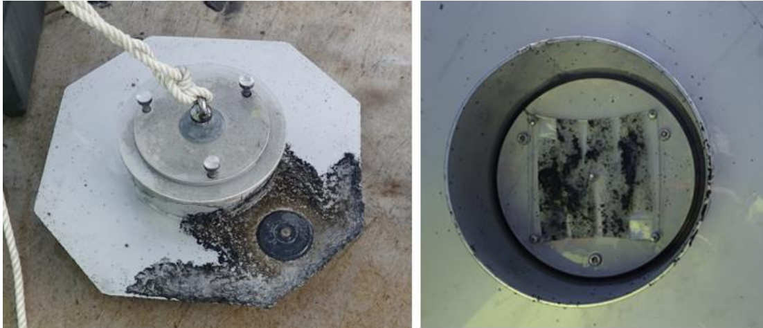
Figur 3: Ved de første 2 prøveomgangene i Store Lungegårdsvann, St. 1-3, var det åpenbart at fluksammeret hadde sunket for dypt ned i sedimentet, og at det hadde vært direkte kontakt mellom SPMD og sediment.
