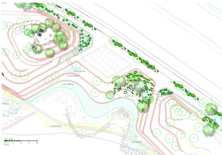
Figur 2. Utsnitt av plantegning som viser at strandparken som skal anlegges skal bygges opp i nivåer, vist i rødt. Bybanen Utbygging leverer område opp til kote 2,5. Deretter skal Bystrand og ny Lungegårdspark forme terrenget, dvs. noe blir høyere enn +2,5 (terrengkollene) mens noe blir lavere enn +2,5 (vikene).
