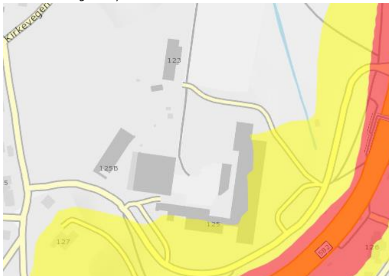
Figur 3.2: Støysonekart fra Statens Vegvesen
