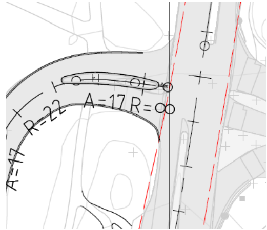
Figur 23 Utbedret tilrettelagt kryssing over Kirkevegen
