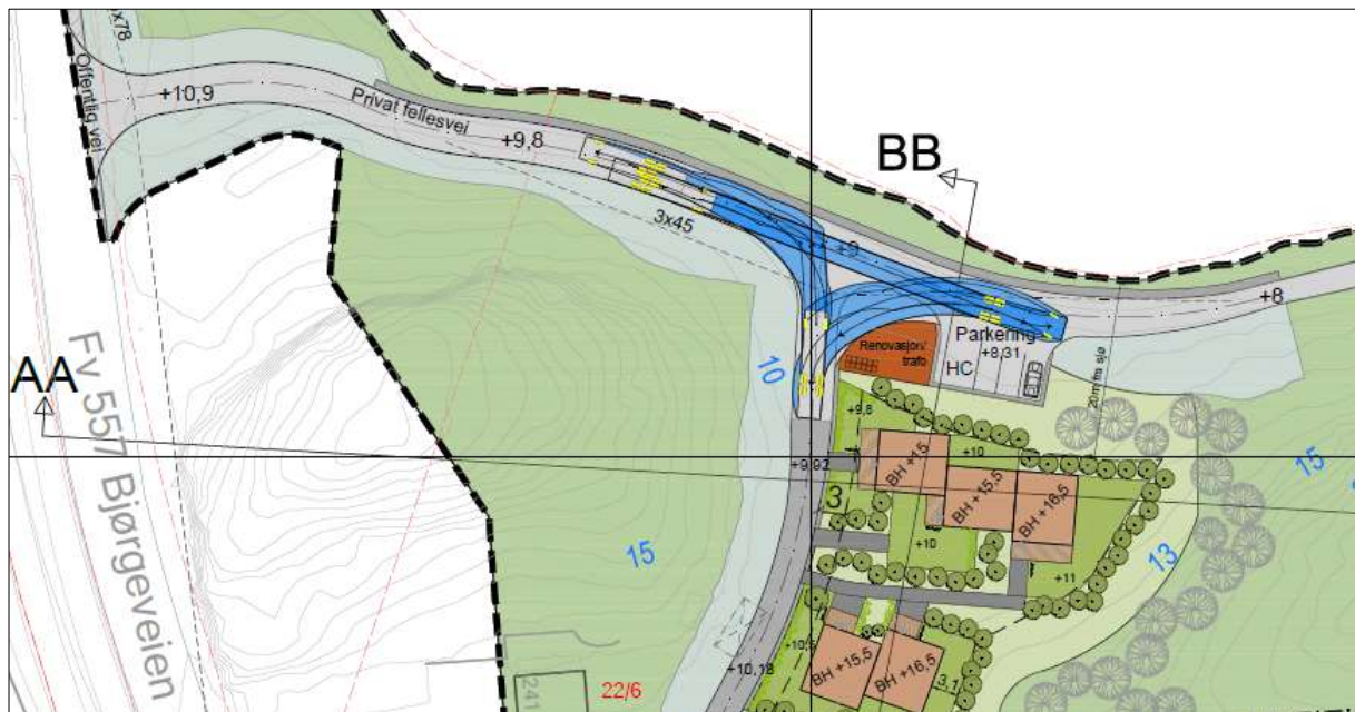
Figur 57 Temakart med illustrasjonsplan med sporing av lastebil (renovasjonsbil) og plassering av renovasjonsareal.
