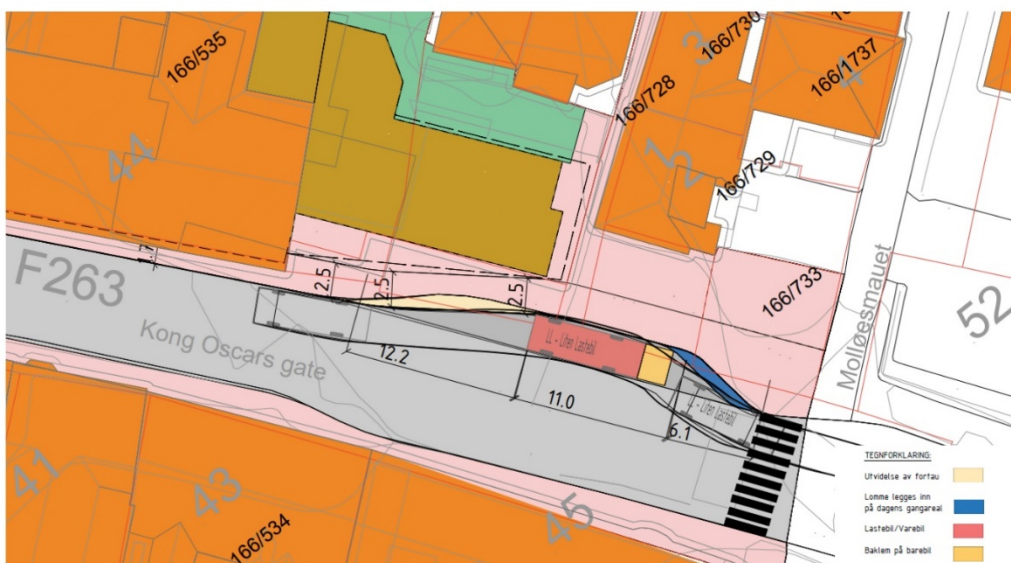
Figur 8 Vareleveringslommen justeres mot sør, vist i blå farge, som frigjør areal for utvidelse av fortau i nord, vist i lys oransje farge.
