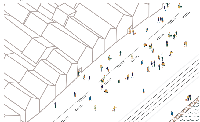
Bryggen en vårdag etter fasadehevingen er gjennomført. Det er fortsatt et skifte i materialitet fra gatestein til granittdekket, og en møbleringssone i overgangen mellom de to gulvene. Trinnene er fjernet og dekket oppleves flatt fra Bryggerekken til Bryggekanten.
