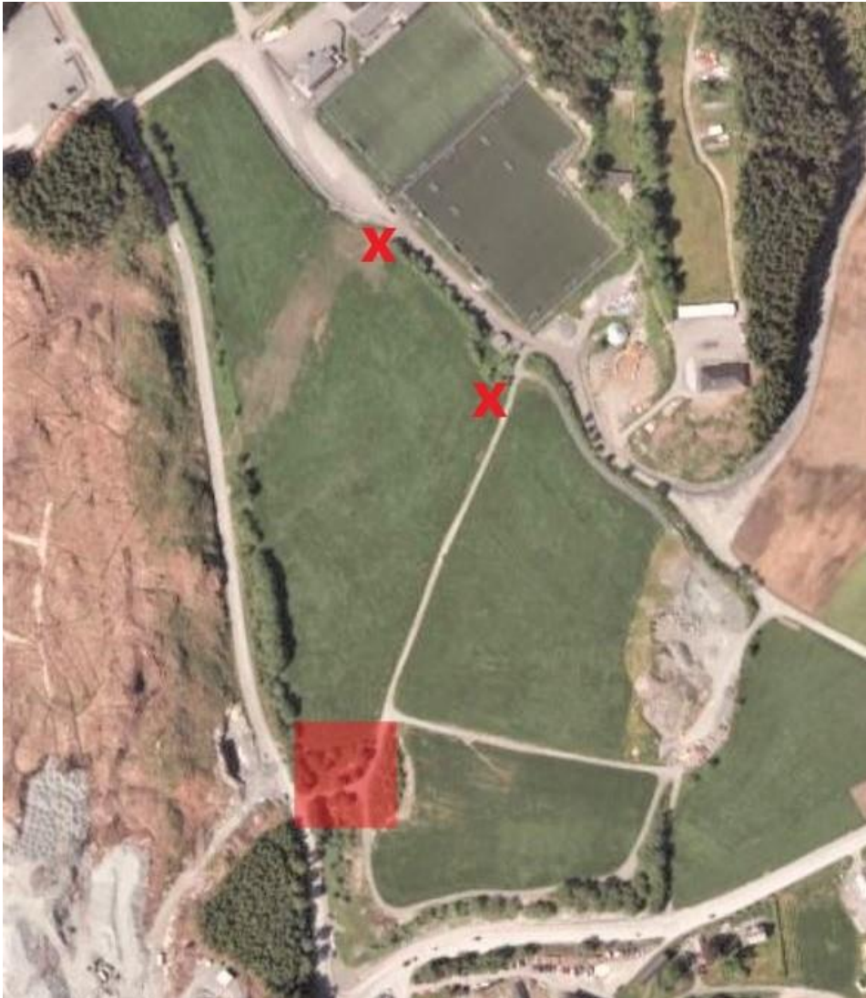
Figur 4. Område sør undersøkt for metanlekkasjer. Rød sone: rundt pumpehus, generelt ca. 400ppm. 30%LEL rundt kanten på kum foran stasjonen. X markerer punktene for funn ved fotballbanen, t.v. 4000ppm, t.h. 180ppm.
