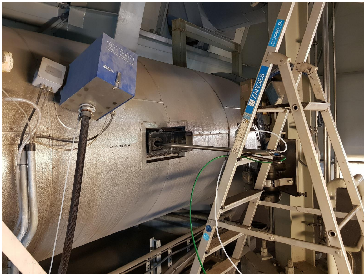
Figur 1. Prøvetaking av røykgass i linje 1. Det ble benyttet dynamisk fortytning.
