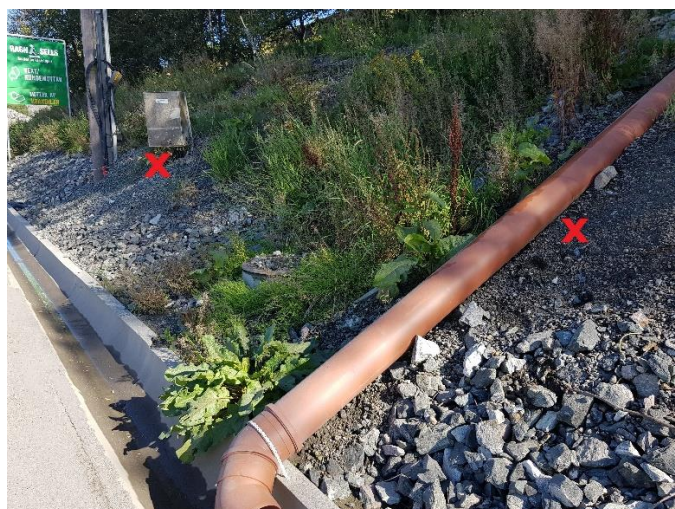
Figur 8. 5%V metan under fiberboks og 6%V ved rør.
