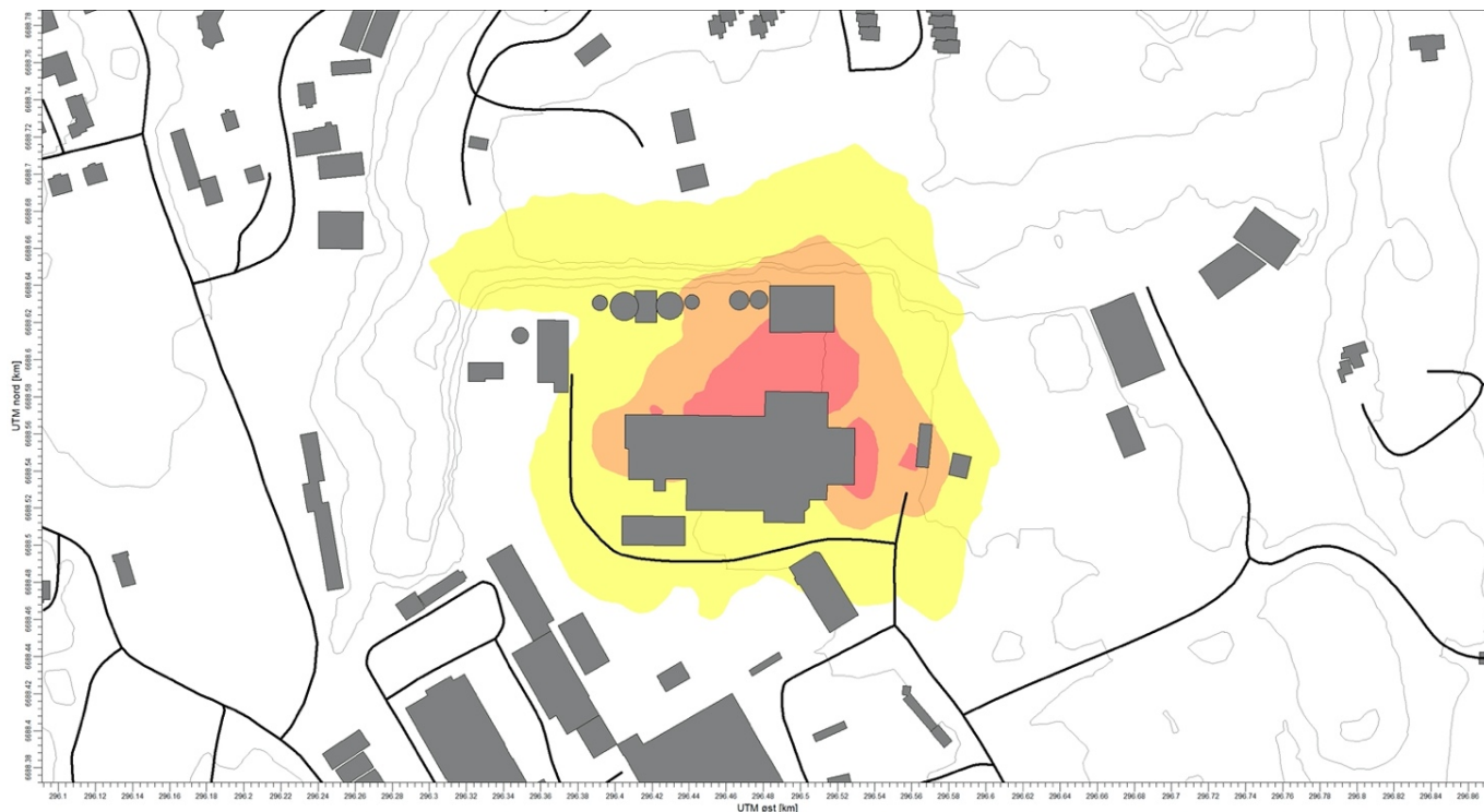
Figur 18. Beregnet bidragskonsentrasjon for normalutslipp fra BIR. RØD: > 2 ou E /m 3 . ORANSJE: 1-2 ou E /m 3 . GUL: 0,5-1 ou E /m 3 .
