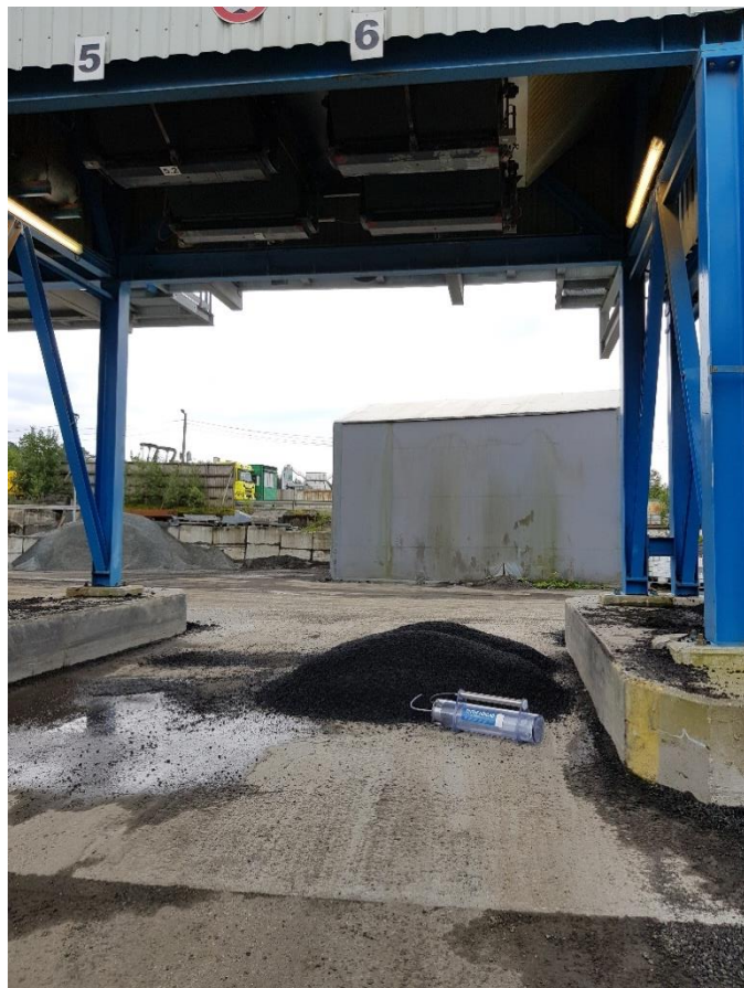
Figur 2. Prøvetaking av asfalt på lasterampe.
