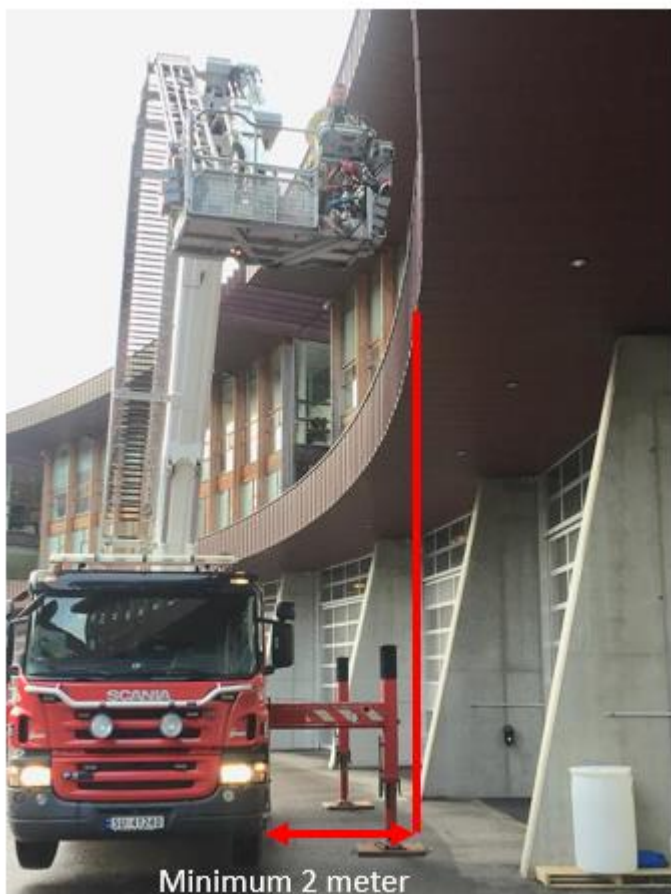
BILDE 3 MINIMUMS AVSTAND VED UTKRAGINGER O.L.
