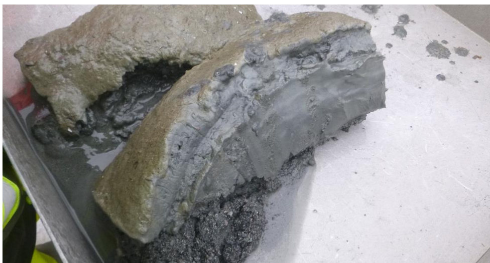
Figur 28 Synlig lagdeling (Delfelt 4B). Brunt topplag over grå TBM-masse. Grovere bunnlag.
