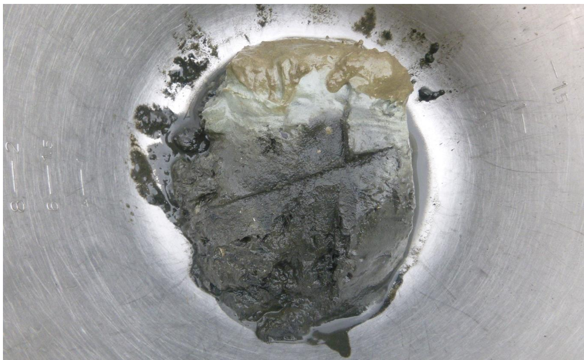
Figur 37 Synlig lagdeling i sedimentet utenfor tiltaksområdet (prøve 9). Brunt topplag over et tynt grått lag med TBM-masser. Mørke, homogene sedimenter i bunn.
