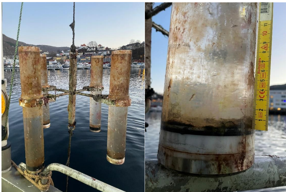
Figur 49 Innhenting av sedimentfeller, ST3 Store Lungegårdsvann sept. 2022.
