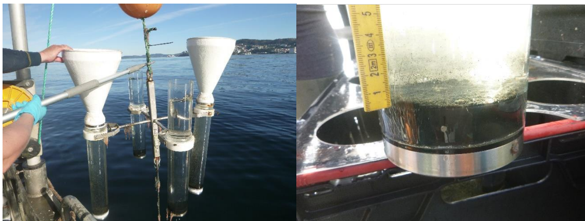
Figur 51 Innhenting av sedimentfeller fra ST11 Ytre Puddefjorden, sept. 2022. Her ble det som et prøveprosjekt benyttet feller med trakt på to av fire rør for å samle mer materiale til analyse. Disse dataene er ikke benyttet i sedimentasjonsrateberegningene.
