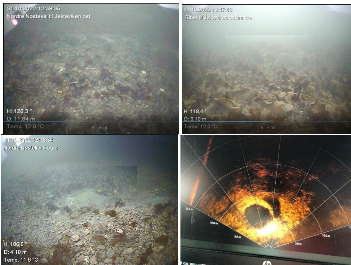
Figur 22 Bilder fra filming i Nøstebukten. Over: Heldekkende erosjonssikringslag. Under til venstre: Grop med eksponert fjell i midten ca. 10 m fra Nordre Nøstekai. Under til høyre: Sonarbilde av gropen med eksponert fjell.
