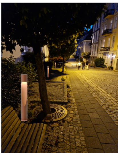
Figur 31 Et eksempel på ekstra belysning, som illustrasjon. I gangsonen ivaretas generell belysning og ansiktsgjenkjenning av overhengte armaturer.
