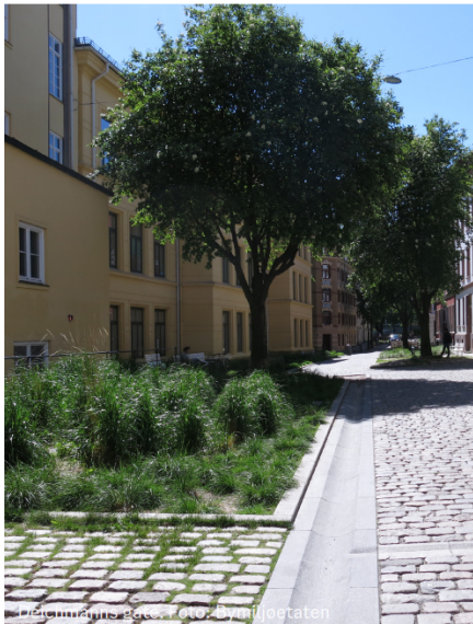
Figur 3-5 Eksempel på etablering av permeabel flater i urbant strøk - Prosjekt Deichmans gate. Kilde: Eksempelsamling OVH Oslo kommune [3]
