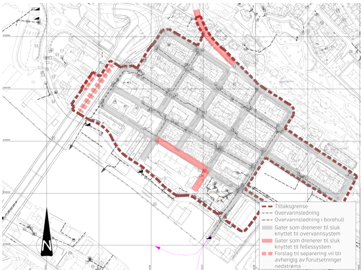
Figur 2-6 Oversikt over eksisterende overvannssystem
