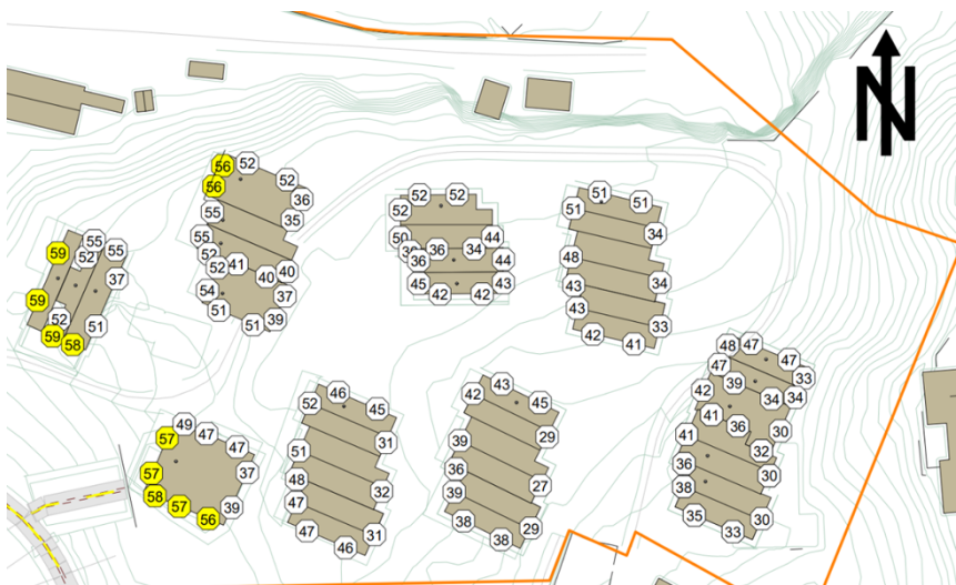
Figur 10 - Utsnitt fra støyrapport som viser støy på fasade.
