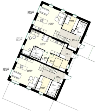
Figur 8: Mulig planløsning for første etasje i låven. Lydkravene kan oppfylles med dette forslaget til planløsning.
