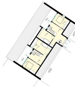
Figur 10: Mulig planløsning for andre etasje i låven. Lydkravene kan oppfylles med dette forslaget til planløsning.
