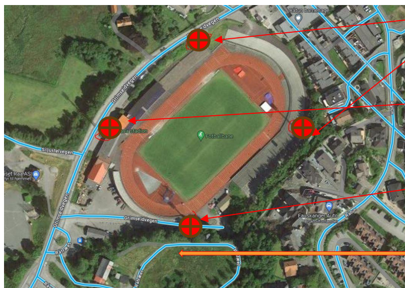
Fire master 40 m med 21X2000W i hver mast dvs 42000 W fra hver mast
