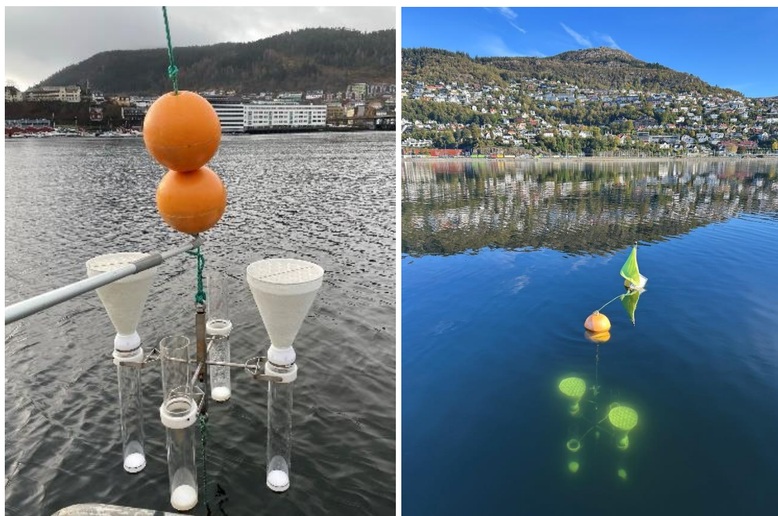
Figur 28 Sedimentfeller med og uten trakter for oppsamling av sediment
