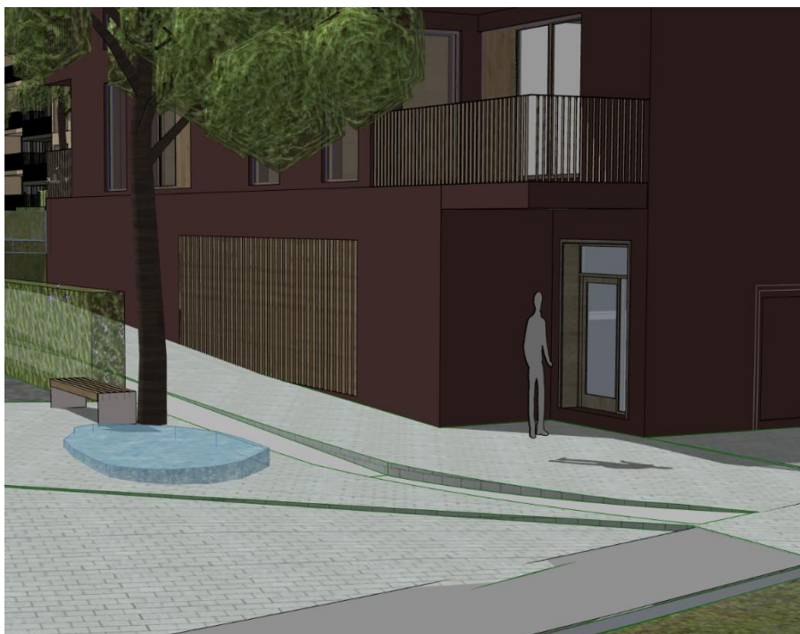
Figur 10 Prinsippskisse av mulig løsning for å integrere bossnedkast i bebyggelse, plassering 2. Inngang til bossrom med dør i fasade.
