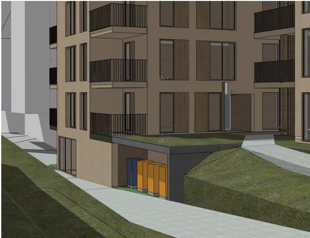
Figur 4 Prinsippskisse av mulig løsning for å integrere bossnedkast i bebyggelse, plassering 1.
