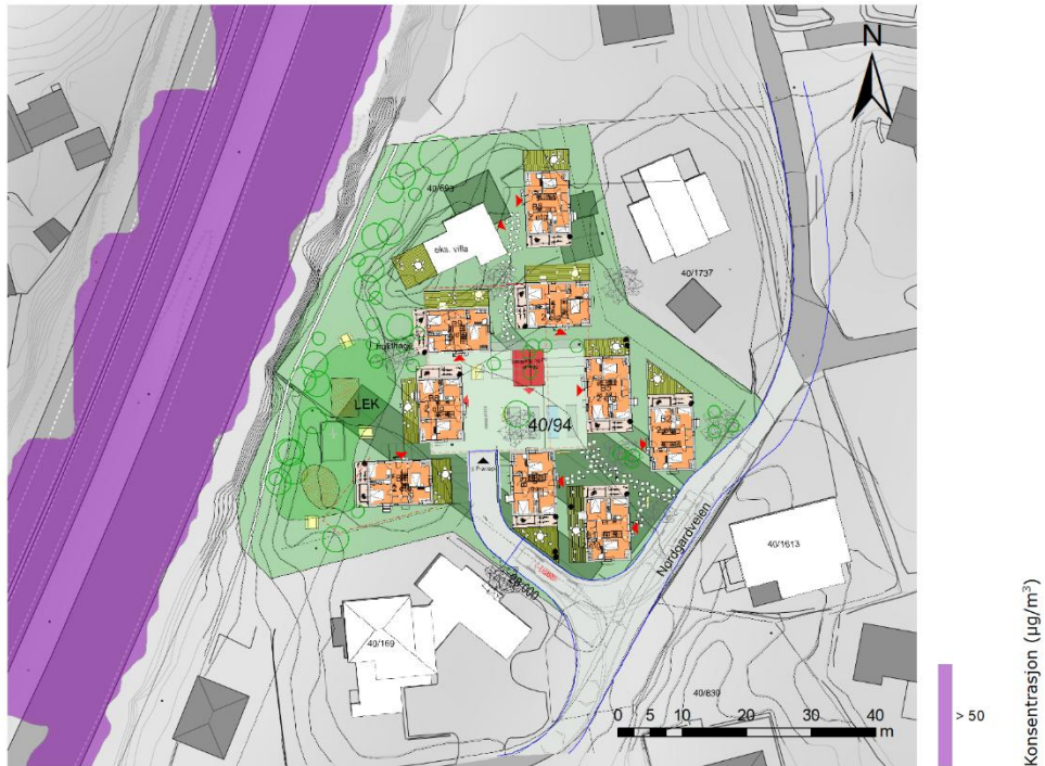
Spredningskart som viser modellerte konsentrasjoner av svevestøv (PM 10 ) som 26. høyeste døgnmiddel ved planområdet for Nordgardsvegen 34 for planforslaget. Situasjonsplanen for tiltaket er vist som bakgrunnskart. Grenseverdien for PM 10 som døgnmiddel i forurensningsforskriften kap. 7 er på 50 µg/m 3 , med tillatt 25 overskridelser.
