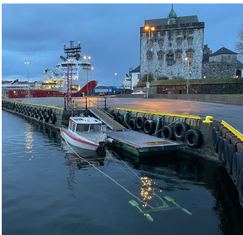
Figur 56 Bilde av kartleggingsfartøyet ved kai i Vågen. Fartøyet har 12 m nedsenkbar arm/bom for styring av de to magnetometerne i gradiometer-konfigurasjonen.
