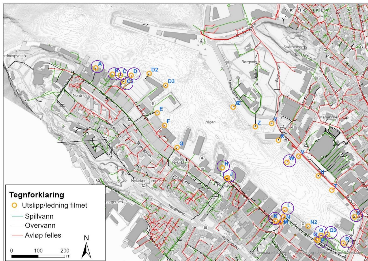
Figur 46 Oversikt over ledninger i tiltaksområdet. Ledningsdata er innhentet fra Bergen Vann 21.11.24. Ledninger/utslipp/vanninntak som kan bli berørt av tildekkingstiltaket i Vågen er markert med lilla sirkler.
