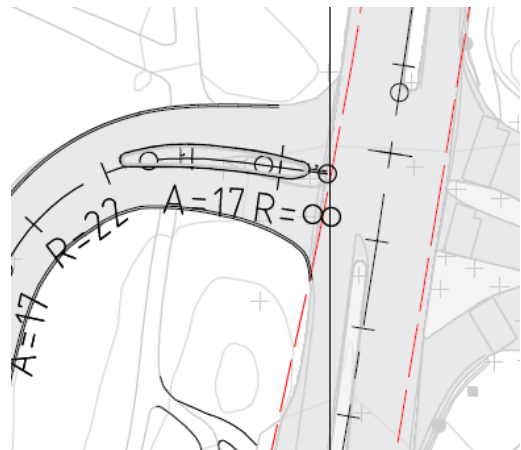
Figur 23 Utbedret tilrettelagt kryssing over Kirkevegen
