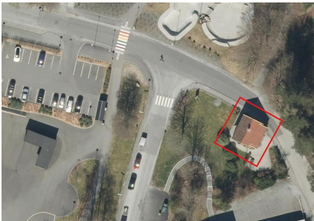
Figur 7 - Utklipp av bygg som skjærer for frisikt
