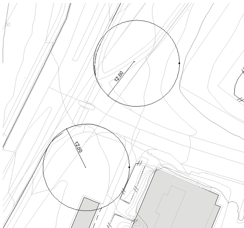
Figur 3 – Utklipp fra modell. Kontroll av radius i kryss
