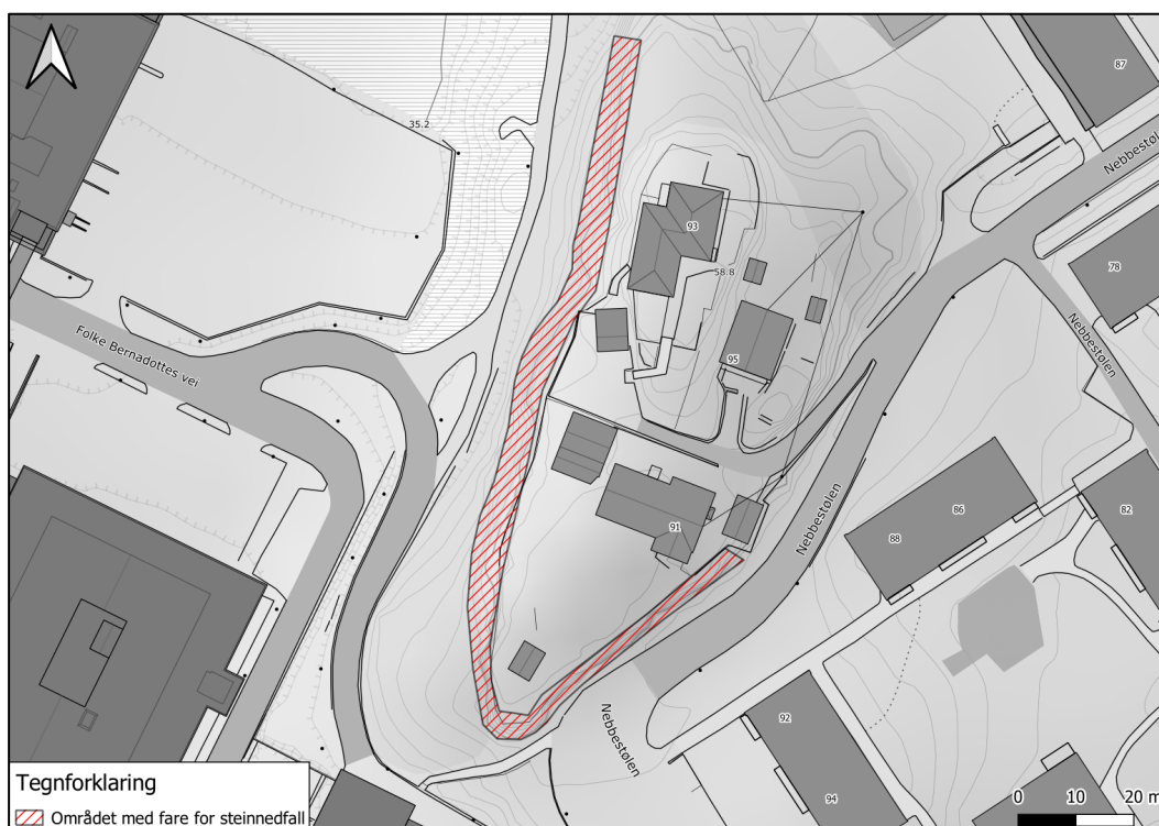
Figur 19 Kartet viser områder med fare for steinnedfall under sprengningsarbeider.
