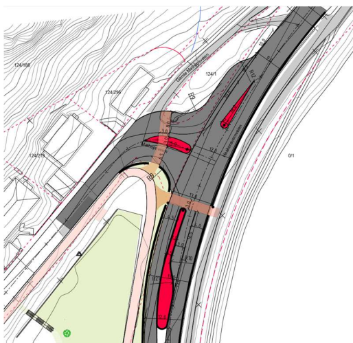
Oversiktstegning, fullkanalisert kryss
