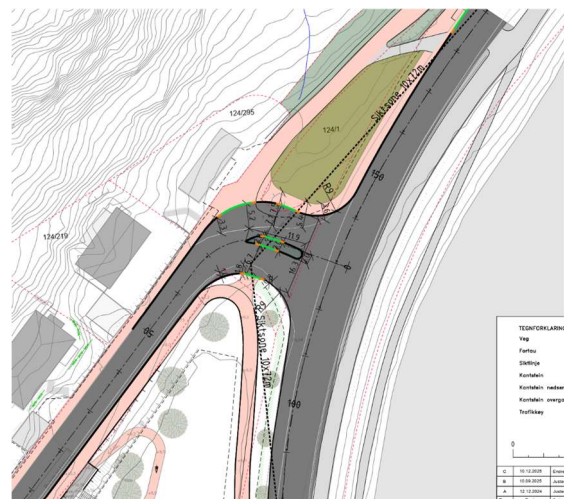
Oversiktstegning, utbedret med dråpeøy og breddeutvidelse
