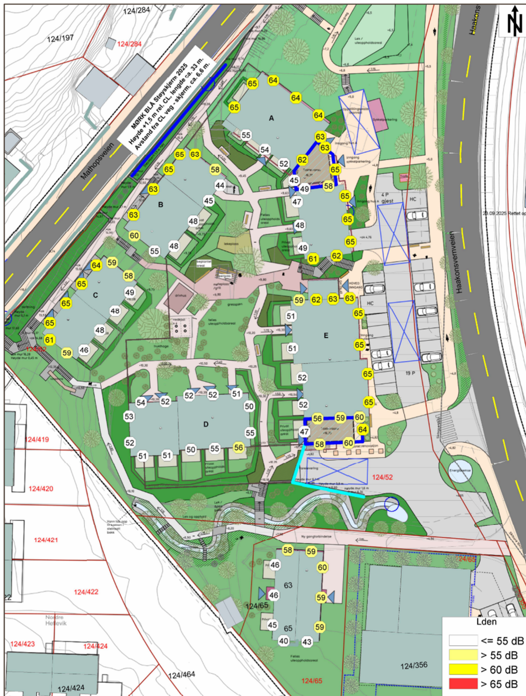
Figur 10. Høyeste ekvivalente støynivå pr. fasadepunkt. L_{den} (dB) inkludert effekt av støyskerm langs Mathopsveien.
