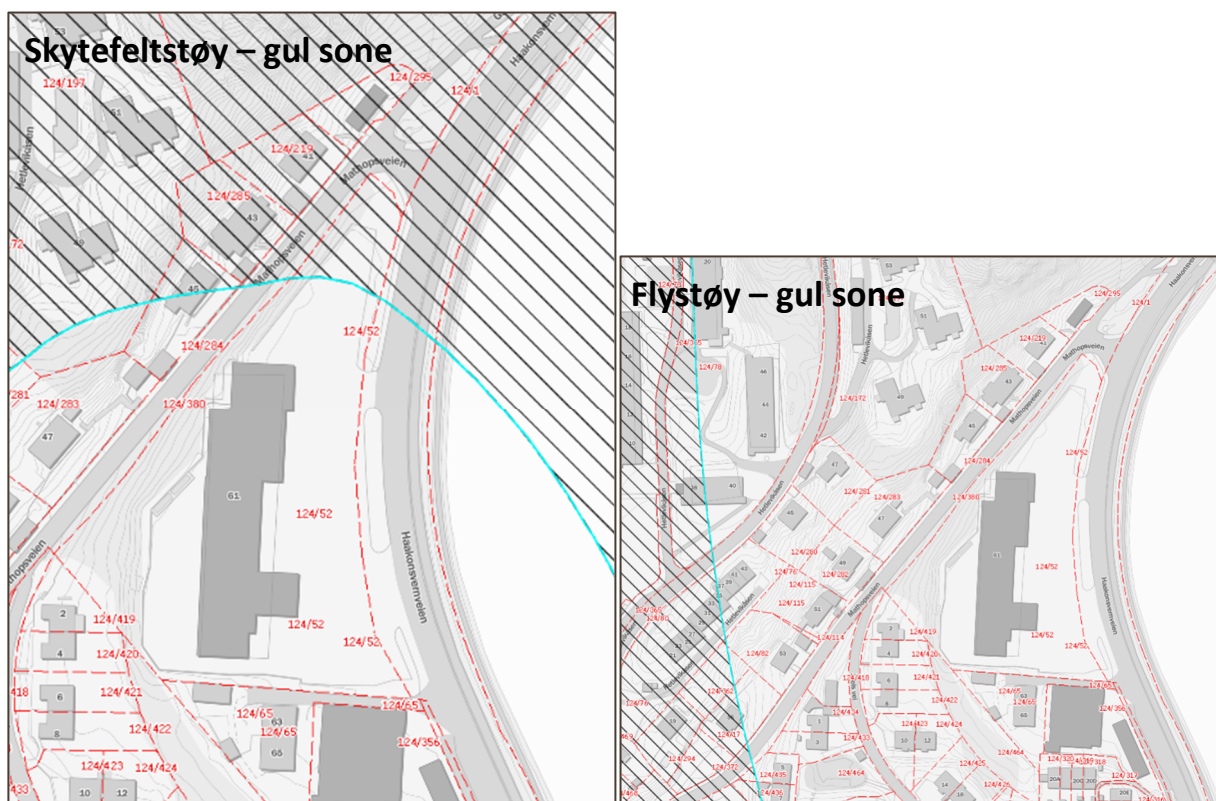
Figur 3. T.v. - Haakonsvern skytefeltstøy, hensynssone: H220 gul sone ( kun nordre del av tomten, som ikke skal bebygges, er innenfor støysonen for skytefelt). T.h. flystøy iht. T1442: 2028 og 2060 prognose, hensynssone: H220 gul sone. (ref. bergenskart.no ).
