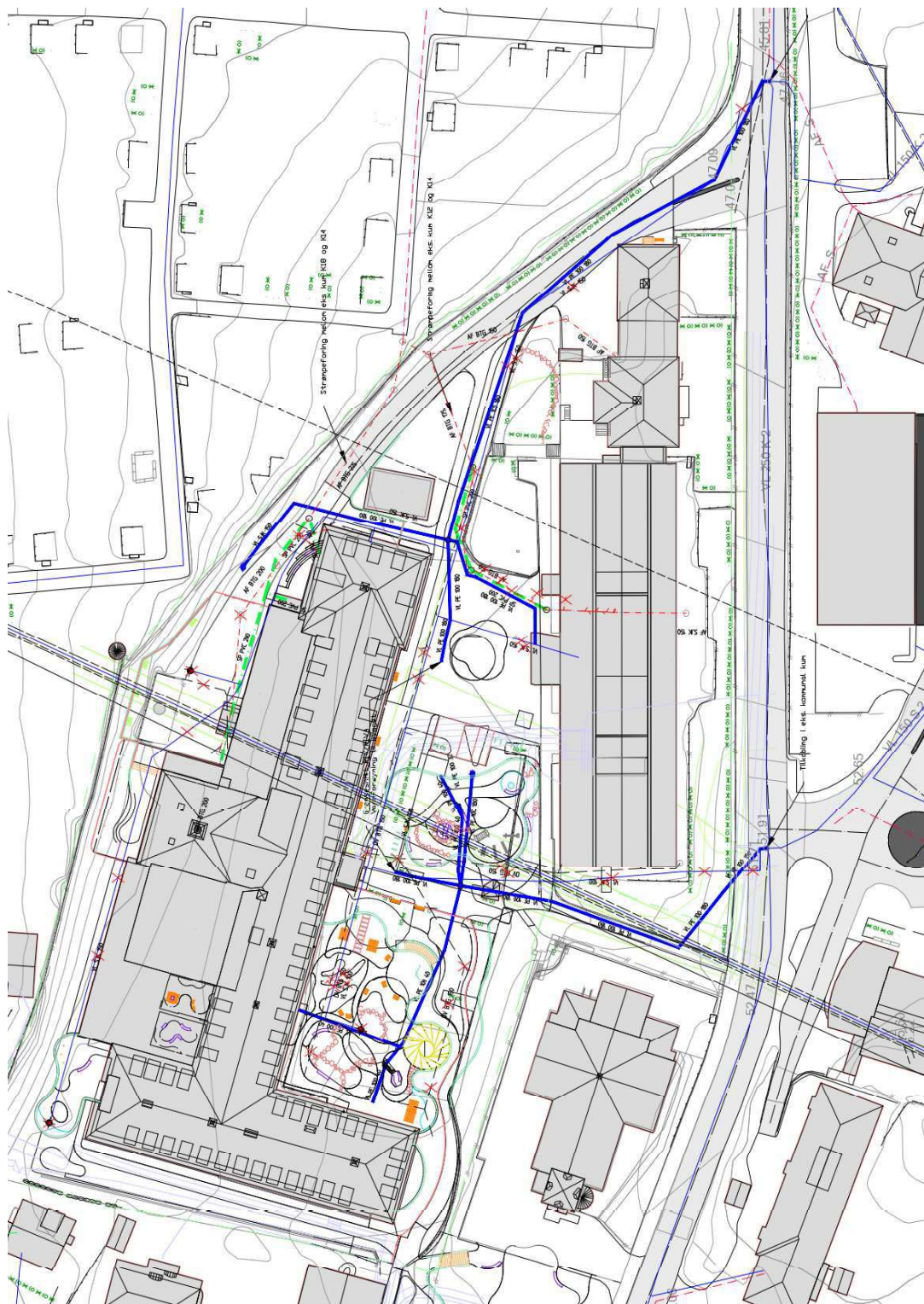
Figur 5 – Planlagt løsning for VA-ledningsanlegg
