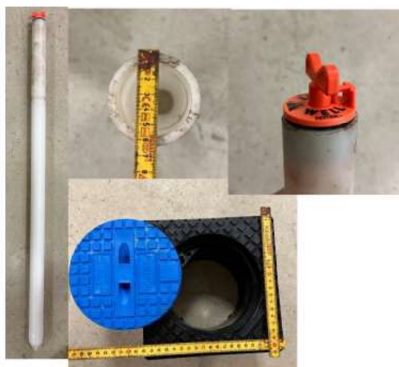
Figur 13 – Utforming og koordinater (NTM5) for grunnvannsbrønner (Rambøll, 11.04.2024)
