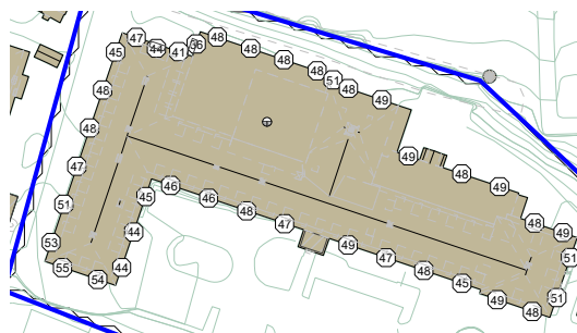
Figur 8: Innfallende lydnivå ( L_{den} ) ved fasade, tredje etasje.
