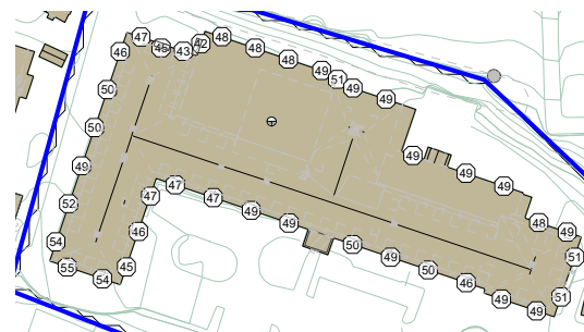
Figur 9: Innfallende lydnivå ( L_{den} ) ved fasade, fjerde etasje.
