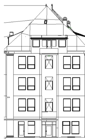
Ny utgang mot nord, vestfløy nye vinduer i plan U1.
