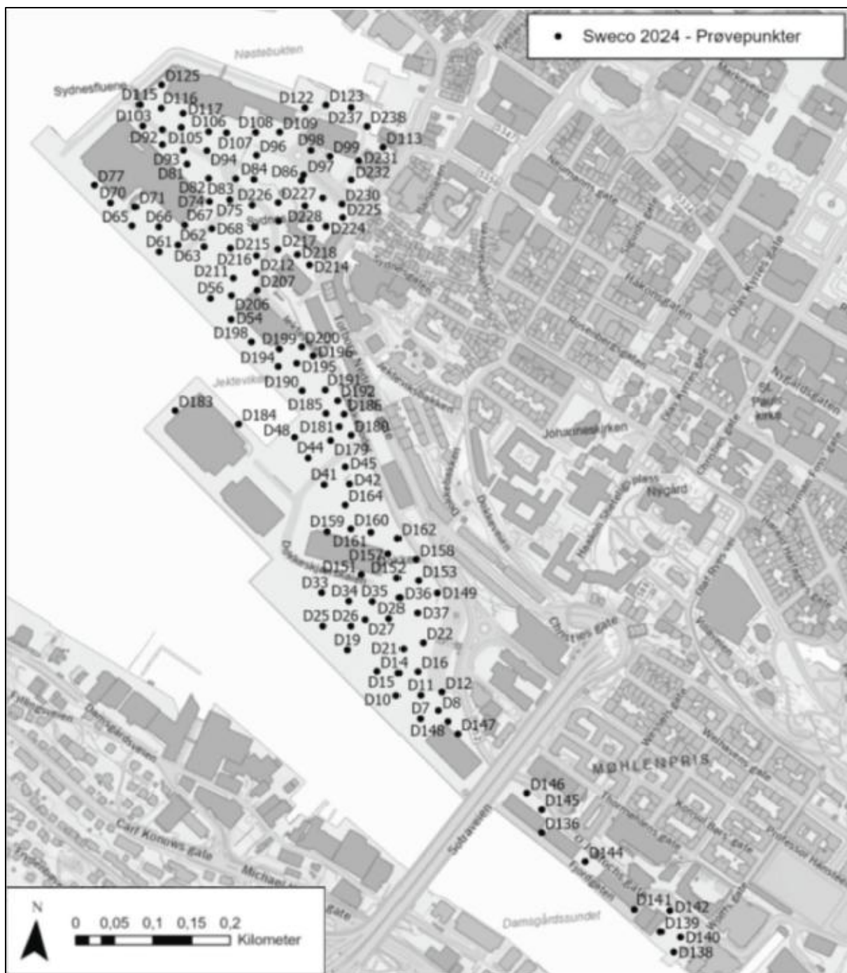
Figur 3-23 Oversikt over Swecos prøvepunkter utført med borerigg i august-oktober 2024 (Miljøteknisk grunnundersøkelse - Dokken, 2024/2025, Sweco).
