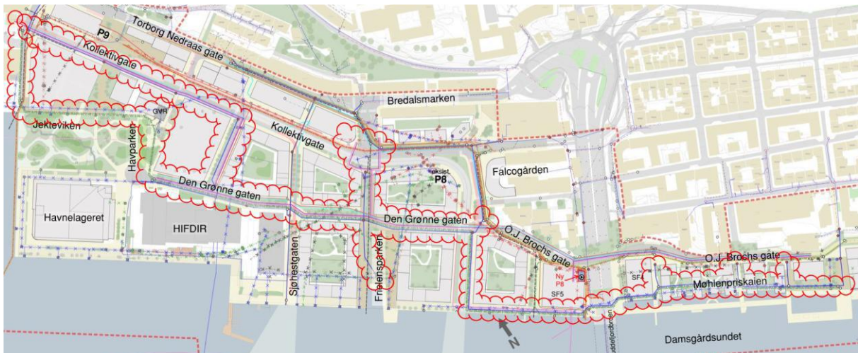
Figur 5-53 viser utsnitt av plangrep med hovedtraséer for nytt lokalt VA-nett for «Dokken Sør». Det henvises videre til tegning H101-102 for detaljert beskrivelse av traseene.
