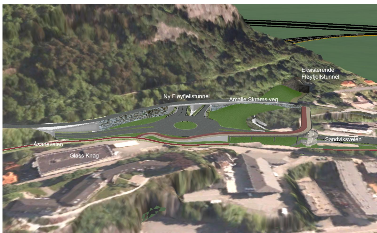
Figur 4-13: 3D-illustrasjon som viser foreslått dagløsning i Sandviken, inkludert gjenfylling av tilløp til eksisterende tunnelportal.
