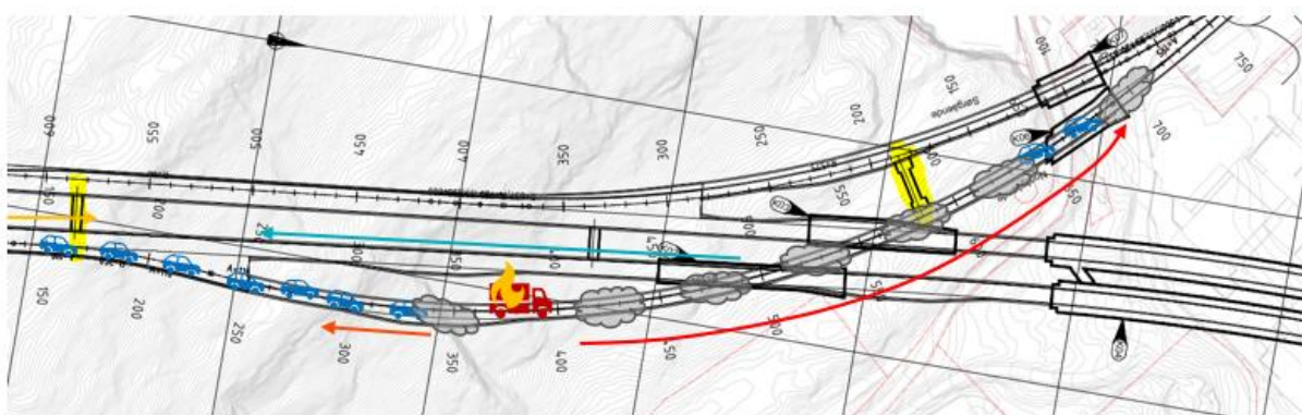
Figur 15 Viser situasjon med brann i tungt kjøretøy i avkjøringsrampe Eidsvåg
