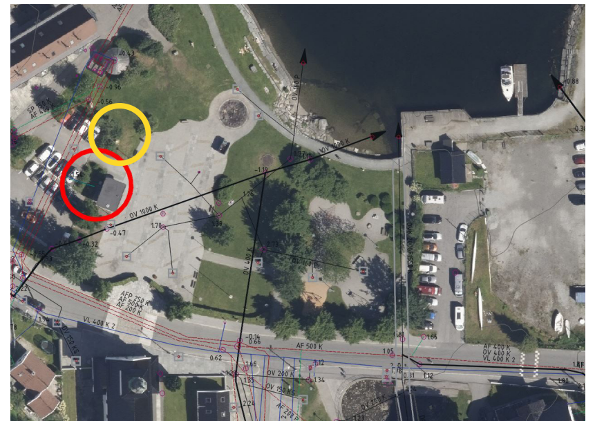
Gul sirkel: Foreslått plassering av nytt toalettbygg Rød sirkel: Eksisterende bygning, Sporveiskiosken, som er tilknyttet de eksisterende stikkledningene for vann og avløp.
