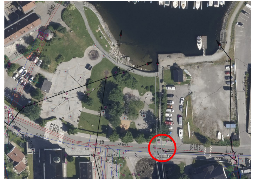
Stikkledning for spillvann på sørøstsiden av tiltaksområdet.
