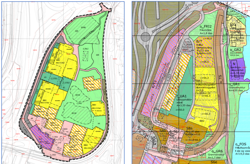
Figur 10: Utsnitt av plankartet som viser foreslått utbyggingsfelt med m 2 BRA, og grøntområder. T.h. utklipp av områdereguleringsplanen der utnyttelsen er oppgitt i %-BRA.
