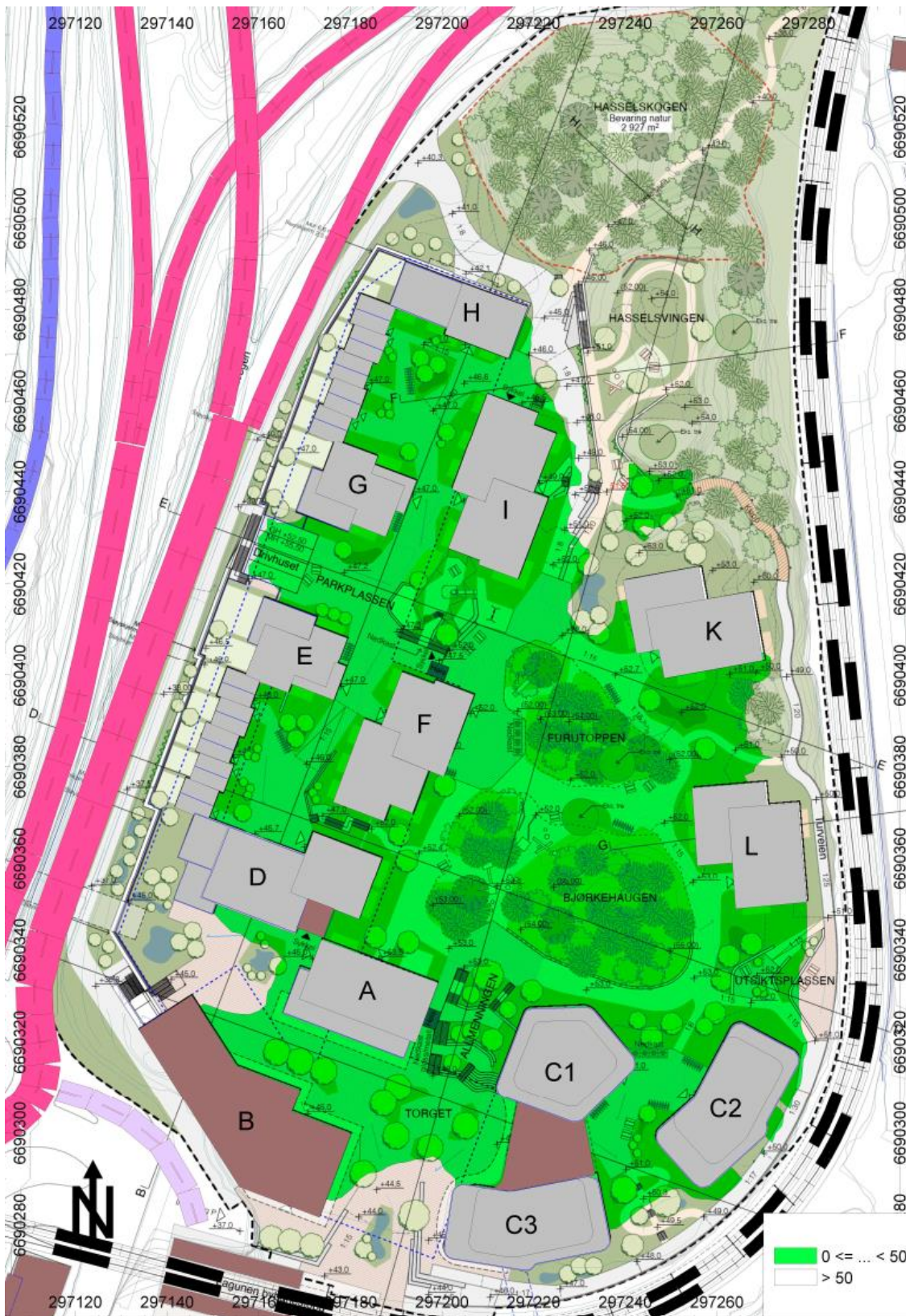
Figur 17: Areal som tilfredsstillers kriteriet for grønn støvsone, L_{den} \leq 50 dB (grønt). Beregningshøyde 1,5 m. Beregnet som sumstøy av både vegtrafikk og bybane.
