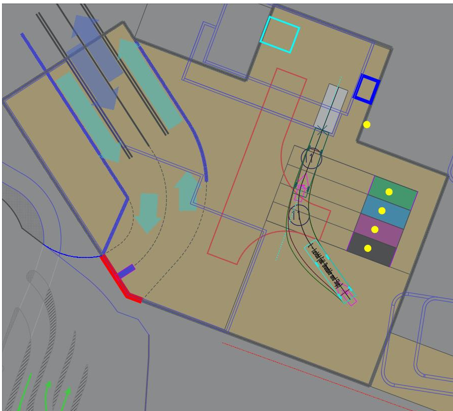
Figur 19: Rygging fra posisjon 0 til container for glass- og metallavfall
