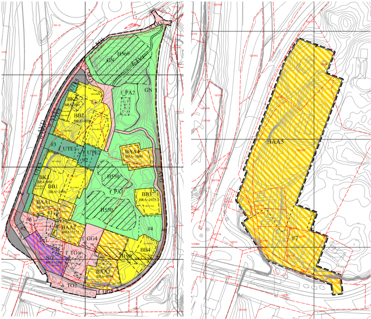
Figur 2: Plankart for vertikalnivå 2 og 1. Bestemmelsesområde #7 er areal satt av til renovasjon og varelevering i vertikalnivå 1.
