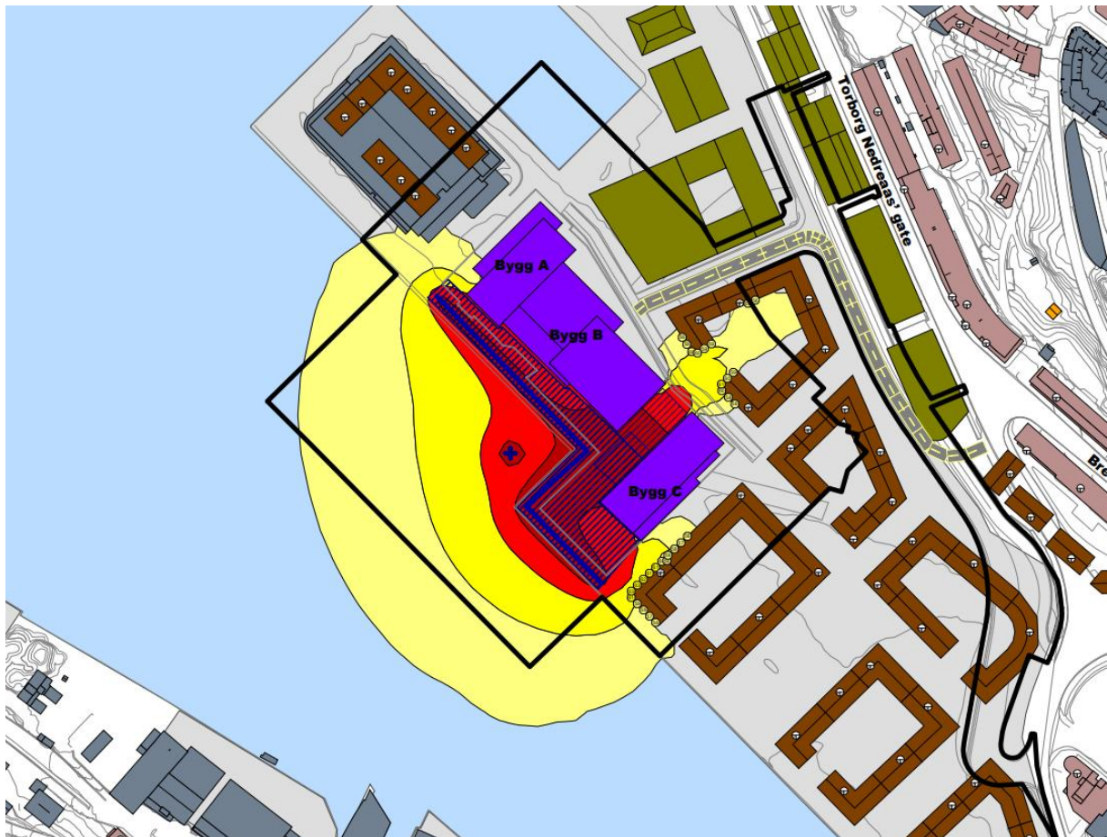
Figur 5-23 Utklipp fra støykart. Støy fra aktivitet tilknyttet Havforskningsinstituttet og Fiskeridirektoratet, mandag-fredag (dagperiode, kl.07-19). Forutsatt støytiltak med innbygging av kompressor. Beregnet Lden 4.0 meter over terreng og høyeste fasadenivå Lden for støyfølsom bebyggelse.
