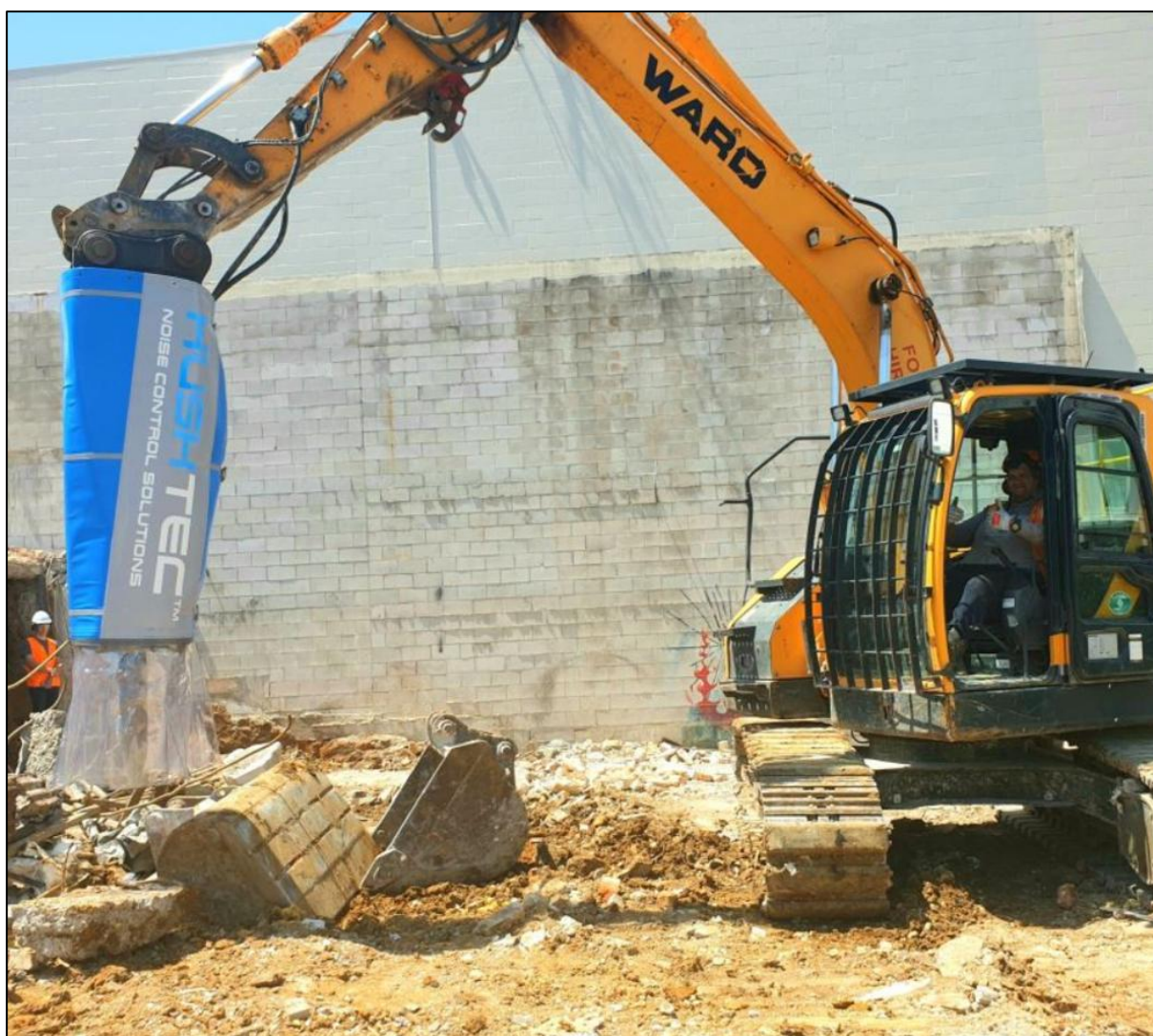
Figur 4-10: Bilde av støydempingskappe på pigghammer. Bildet er hentet fra Ankerløkken sine hjemmesider.
