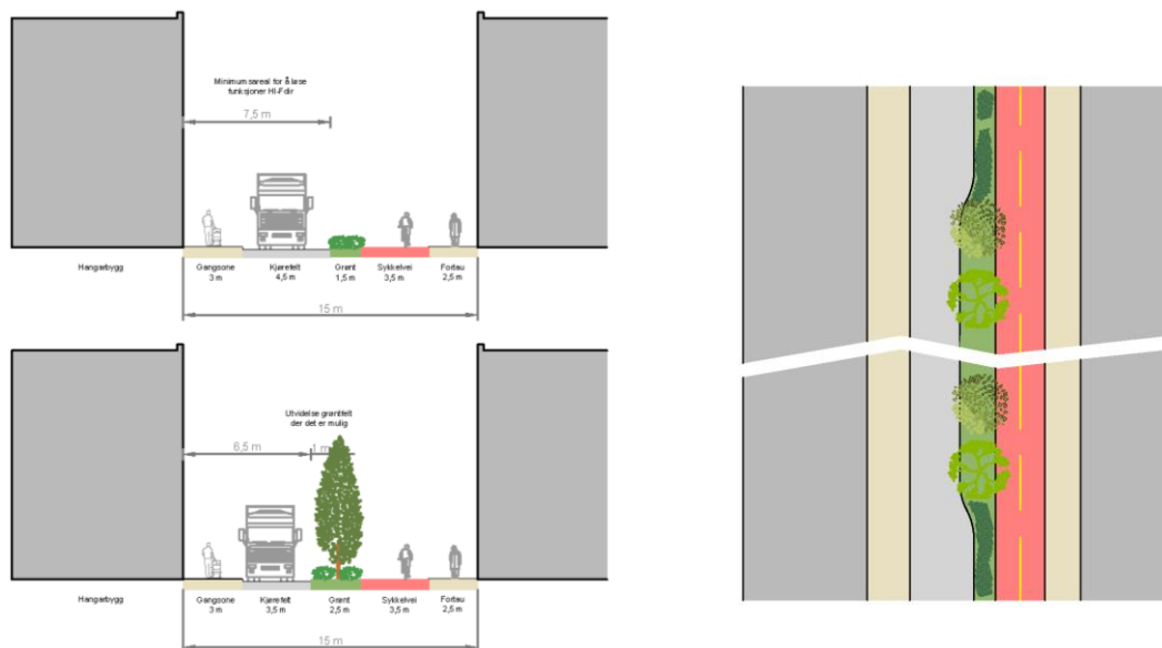
Figur 6-4: Snitt som viser en mulig løsning for «Sjøhestgaten» med deling mellom fortau, sambruk, grønt og sykkelvei.
