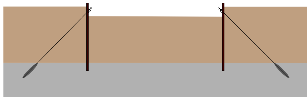
Fase 3: Installasjon av puter og ankere
