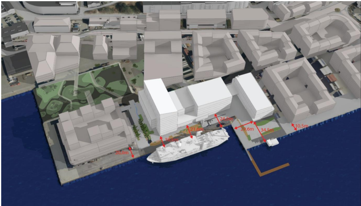
Figur 3-12: Kaibredder i forprosjektet
