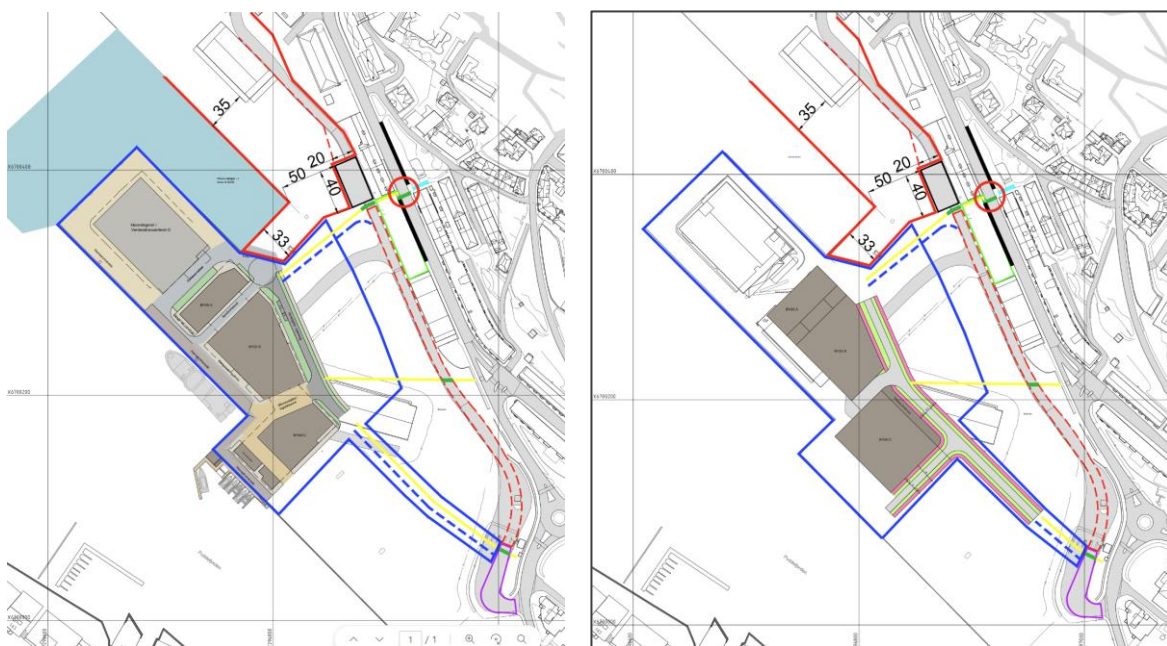
Figur 5-1 Skisse for løsninger i mellomfasen - vist med alternativ 1 t.v. og alternativ 2 t.h. Røde stiplede linjer er havnetrafikk, rød heltrukket linje er ny havnegrense (ISPS), blå er kjøretrafikk til tomten, gule linjer er gående/syklende. Rød sirkel er mulig nytt overgangsfelt, sorte streker er mulig nye bussholdeplasser, turkis er mulig ny trapp. Blå heltrukket linje er foreslått rigg og anleggsområde.
