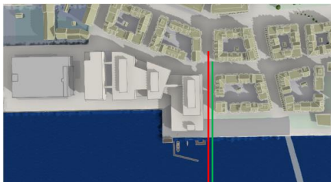
Figur 4-4 Plassering av hhv. bybane (rød) og gang/sykkelbru (grønn) i alternativ 1 t.v. og alternativ 1 t.h.
