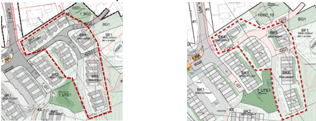
Figur 7: Oversikt over boliger som ikke vil få universell tilkomst fra bolig til parkering (boliger innenfor stiplet linje). Illustrasjonsplan til offentlig ettersyn – 18 boliger (til v.), illustrasjonsplan til sluttbehandling – 16 boliger (til h.)
