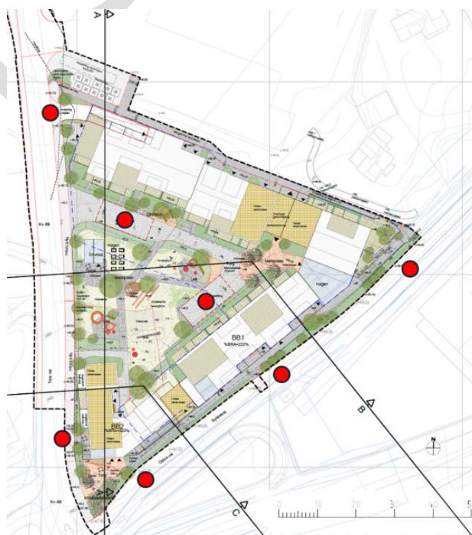
Figur 4-27 Løsningsforslag for oppstillingsplasser brannbil (røde sirkler).
