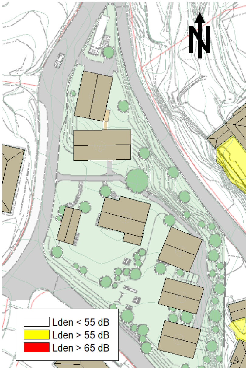
Figur 2: Støytbredelse ( L_{den} ) fra støy fra vegtrafikk for 2042 for planområdet. Beregningen er 1,5 m over terreng, i vanlig vurderingshøyde for uteoppholdsareal.
