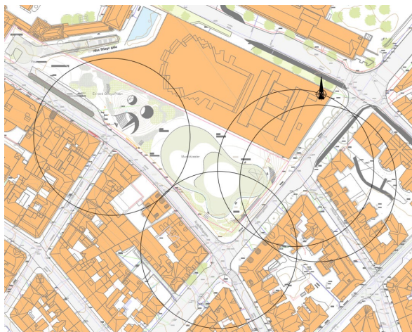
Figur 7-6 Oversikt over brannvannsdekning fra eksisterende vannkummer i Strømgaten og Nygårdsgaten. Sirklene representerer 50m fra uttak i kum. Kilde: VA-rammeplan
