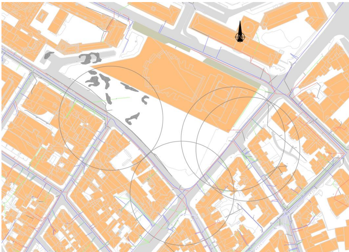
Figur 4.2: Oversikt over brannvannsdekning fra eksisterende vannkummer i Strømgaten og Nygårdsgaten. Sirklene representerer 50m fra uttak i kum.
