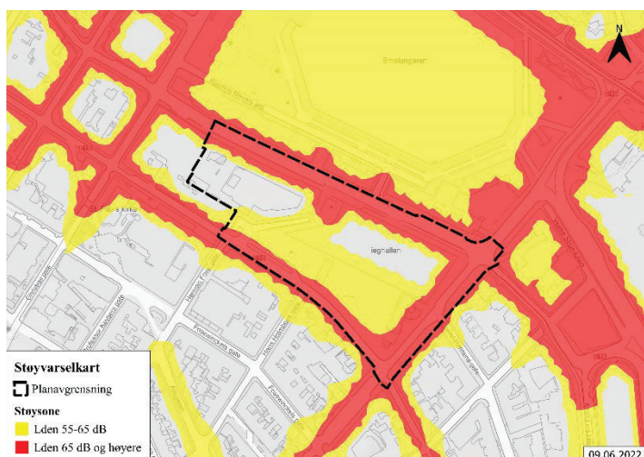
Figur 5-11: Kart som viser støyvarselkart for planområdet. Støyvarselkartet er utarbeidet etter T-1442. Kartgrunnlag: FKB.
