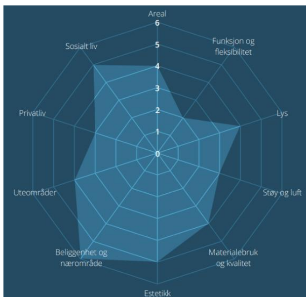
Figur 27 Illustrasjonen viser et eksempel der det skåres høyt på beliggenhet, nærområde og sosialt liv, men lavere på funksjon og fleksibilitet – for eksempel en liten og trang bolig med sentral beliggenhet. Kvalitetsrosen kan dermed fungere som et verktøy for å synliggjøre styrker og svakheter ved konkrete boligprosjekter, og understreker behovet for helhetlige vurderinger av bokvalitet. Illustrasjon: «Gode boliger for alle»
