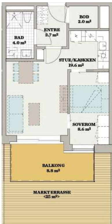
Figur 25 I en serie artikler i Aftenposten i 2018 undersøkte avisen kvaliteten i flere nye boliganlegg i Oslo. I plantegningene for leiligheter i Lørenporten ble det visst små leiligheter på totalt 37,9 m 2 med kjøkken dypt inne i et hjørne, uten direkte tilgang til daglys fra et vindu.
