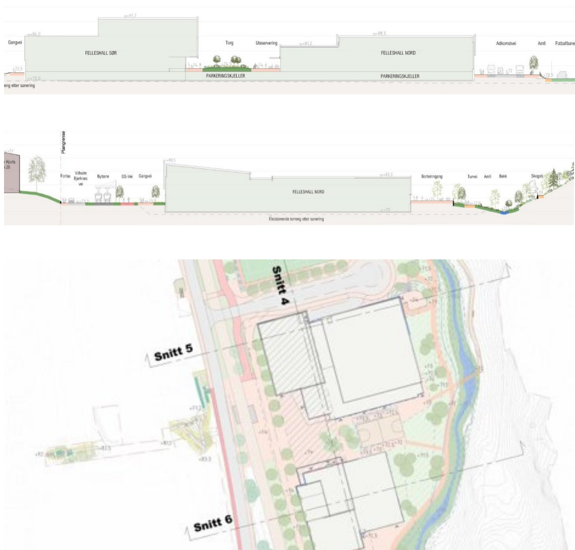
Figur 5-26: Snitt 4 øverst av torg over parkeringsareal, og adkomstvei med oppstillingsplass for spillerbuss. Snitt 5 som viser hvordan bybaneholdeplass, torg, første etasje i felleshall og aktivitetspark ligger på samme nivå og knyttes sammen. Norconsult (2026).
