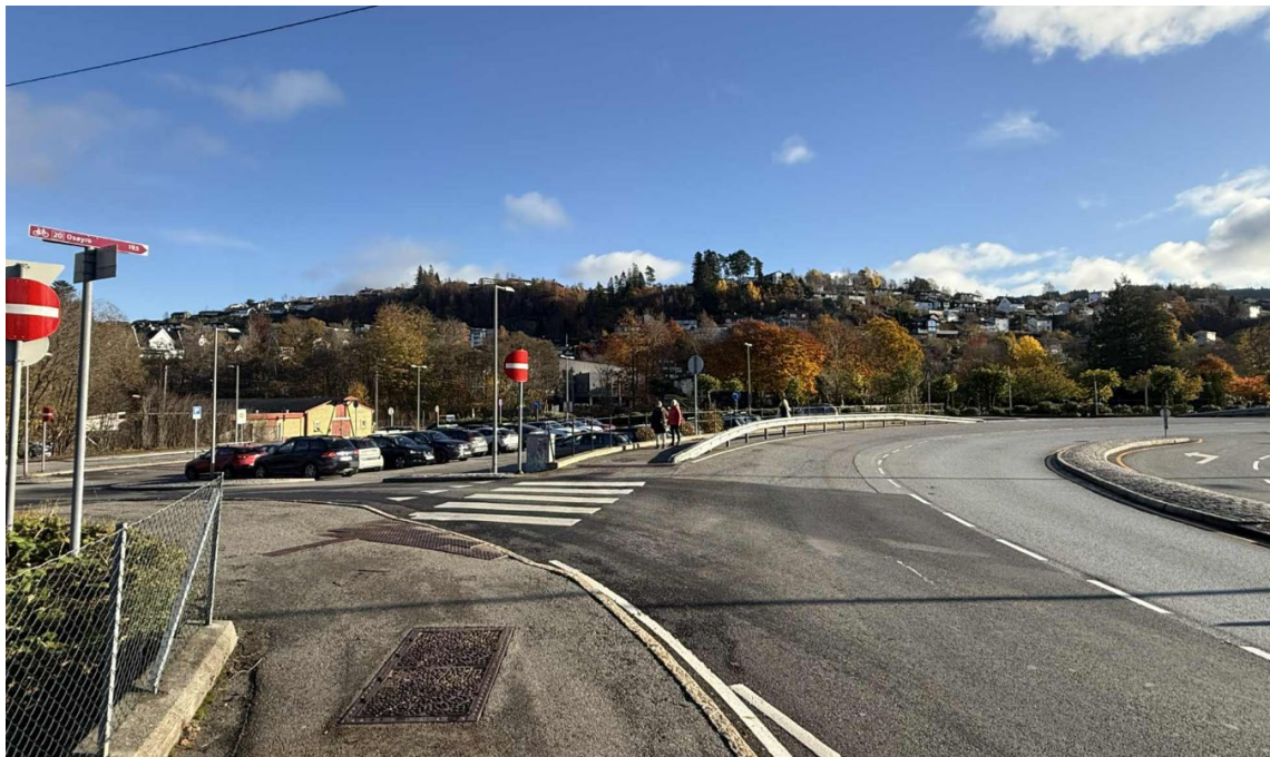
Figur 22. Utkjøringen fra planområdet er påbudt høyresving inn på Osvegen der trafikknivået er halvert fra ca. 18000 ÅDT i 2021 til ca. 9.000 ÅDT i dag. Kapasiteten på høyresvingen er god, og det er ikke forventet problemer med trafikkavviklingen i krysset.
