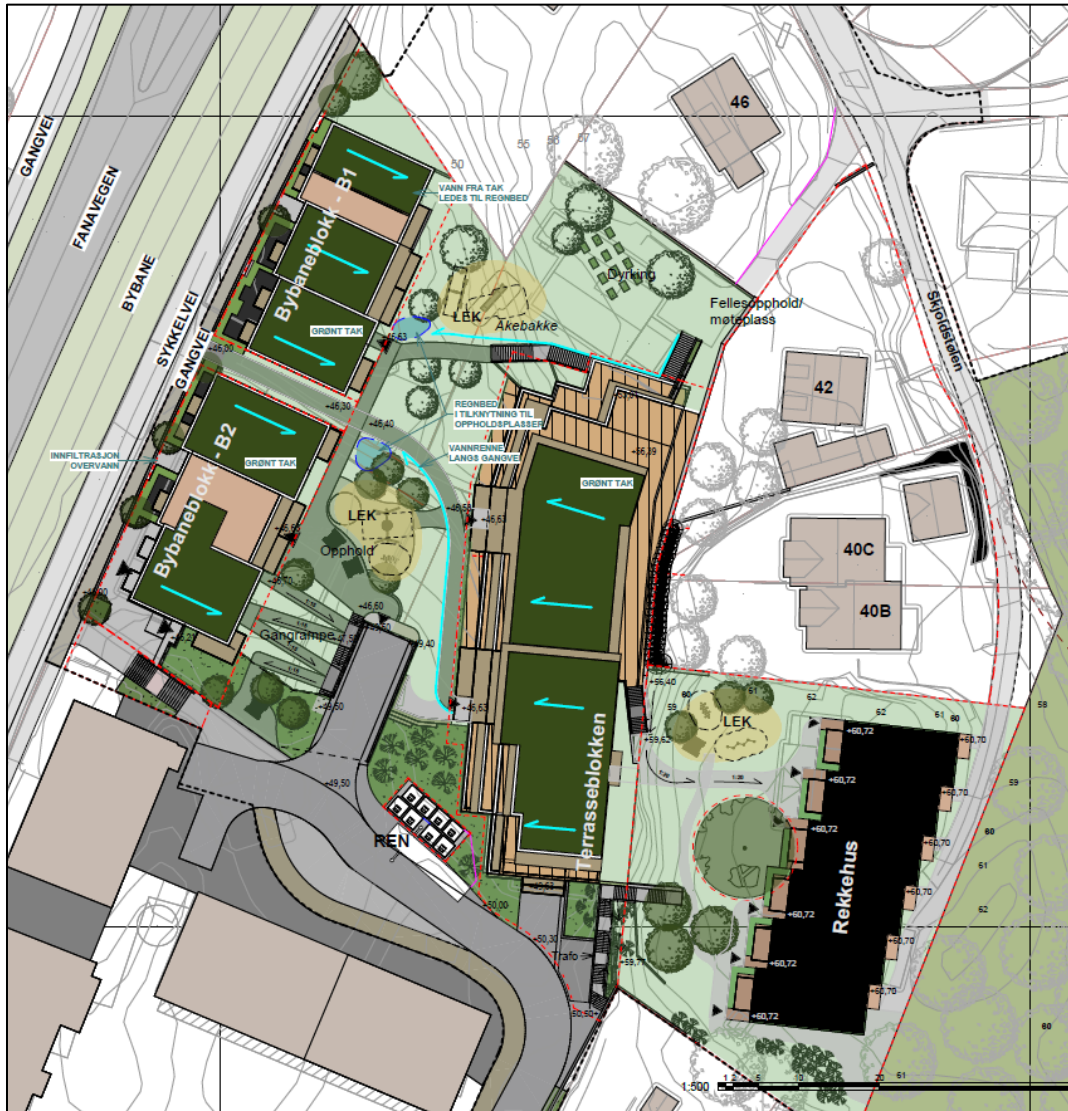
Figur 69. Prinsipp for overvannshåndtering etter utbygging. (Sweco Archtiects)
